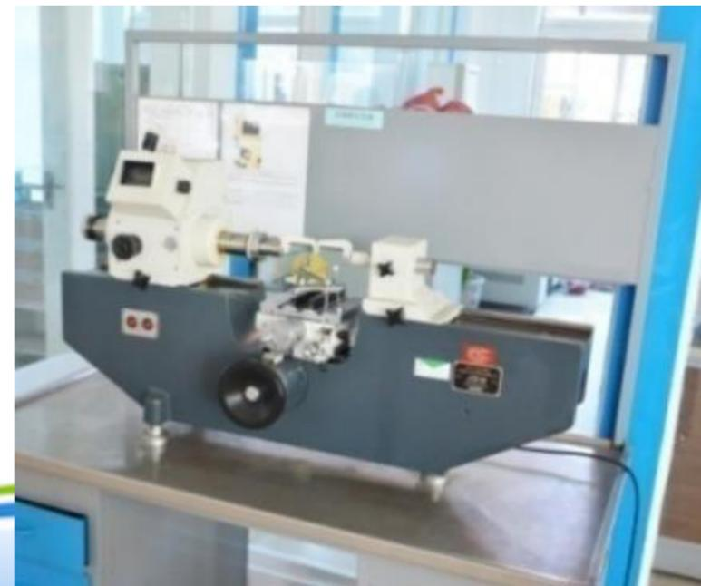
轴承跳动精度测试仪
